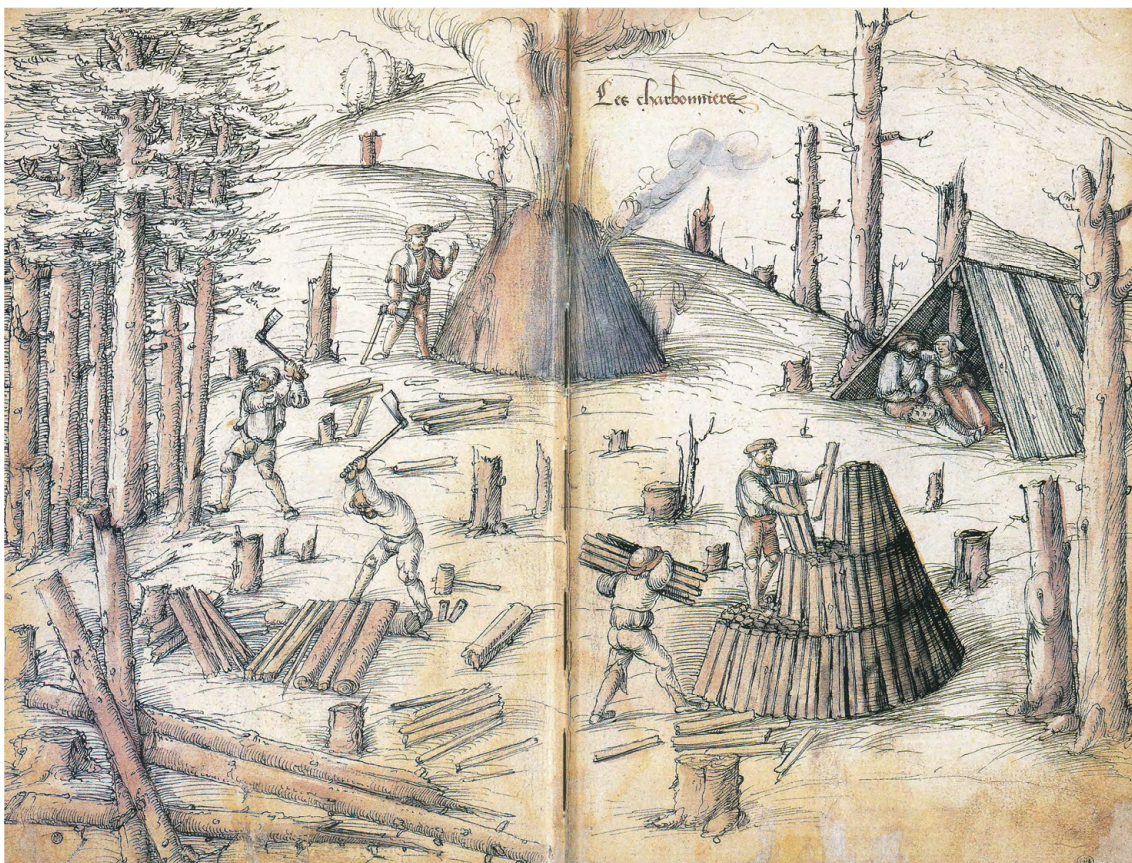
Abbildung 72: Holzkohleerzeugung in den Vogesen nach Heinrich Gross (Quelle: Brugeroles, [u.a.] S. 48 – 49).
