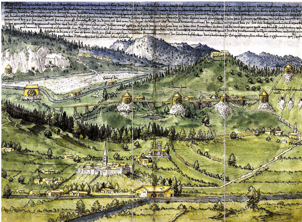
Abbildung 79: Bergwerkslandschaft bei Kitzbühel im Schwazer Bergbuch 1556 mit Wasserleitungen, um die Wasserräder (Pumpwerke, Pochwerke,...) anzutreiben zu können (Quelle: Bartels, [u.a.] 2006, S. 936).
