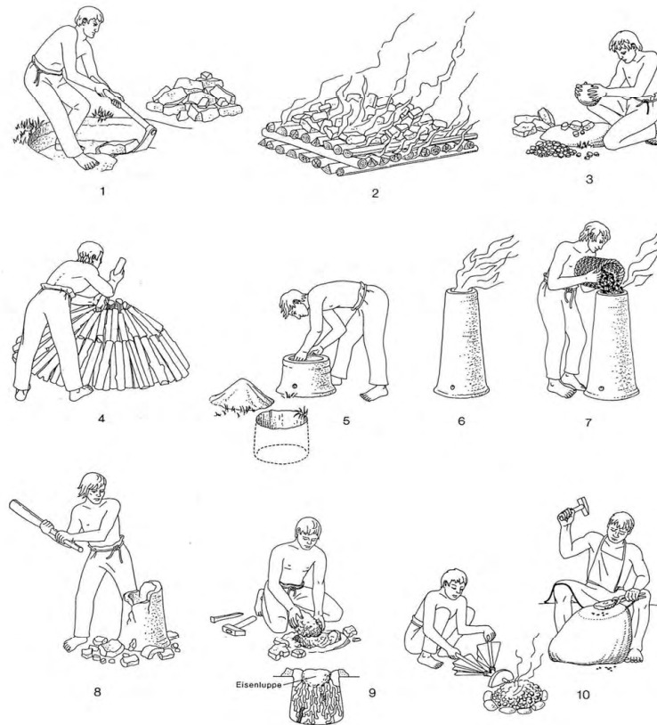
Abbildung 4: Eisengewinnung im norddeutschen Flachland – vom Erz zum Metall; 1. Erzabbau; 2. Rösten des Erzes; 3. Pochen des gerösteten Erzes; 4. Holzkohleproduktion mit Hilfe eines Meilers; 5. Ausheben der Schlackegrube und Aufbau des Ofenschachtes; 6. Vorbrennen des Ofenschachtes; 7. Beschicken des Rennfeuerofens mit Holzkohle und aufbereitetem Erz; 8. Zerschlagen des Ofenschachtes nach dem Verhüttungsprozess; 9. Herausbrechen der Eisenluppe; 10. Reinigen und Verdichten des Eisens; (Quelle: Hauke 1993, S. 64).
