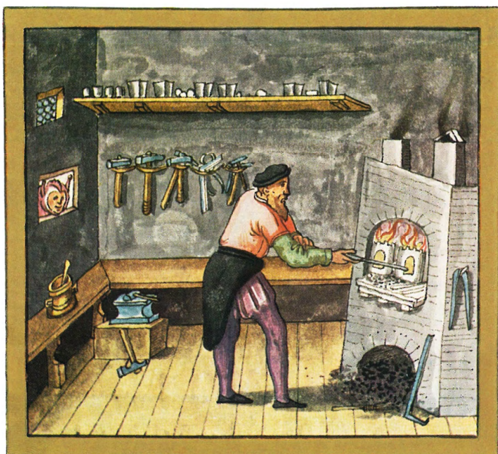
Abbildung 22: Der landesfürstliche Probierer bei seiner Arbeit vor dem Probierofen (Quelle: Winkelmann 1956, S. 78).
