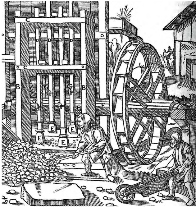
Abbildung 43: Ein mit Wasserkraft betriebenes Pochwerk (Quelle: Agricola 2006, S. 244).
