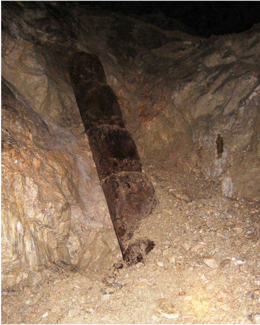
Abbildung 41: Steigbaum in situ in einer Grube am Falkenstein bei Schwaz (Foto: Neuhauser 2009).
