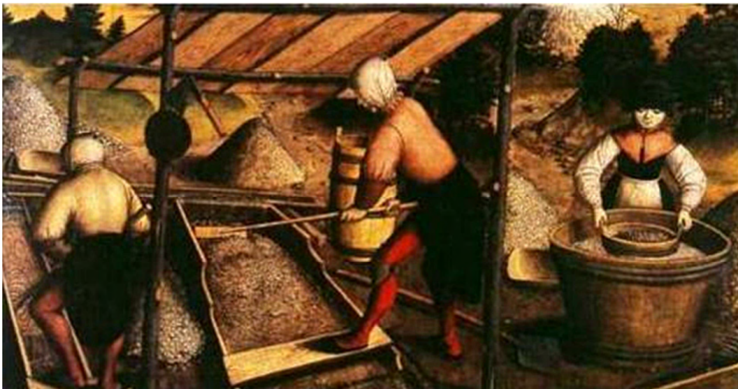
Abbildung 78: Sieb- und Kruckenwäsche auf dem Altarbild der St. Annakirche von Annaberg im Erzgebirge (Quelle: Wilsdorf 1987, S. 179).
