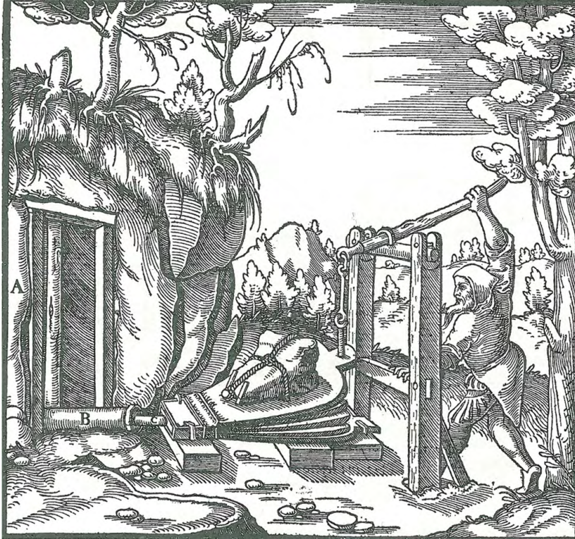
Abbildung 34: Focherbube beim Betätigen des Fochers (Blasebalg), um die Frischluftzufuhr in der Grube sicherzustellen (Quelle: Agricola 2006, S. 180).
